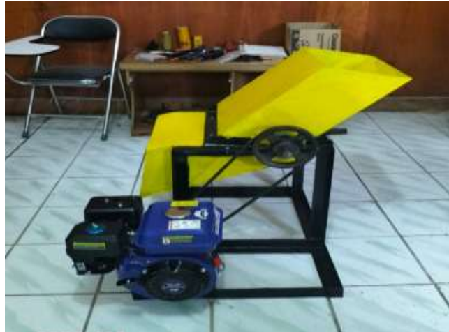
Gambar 2. Mesin Pamarut Batang Sagu Kapasitas 30 Kg perjam
