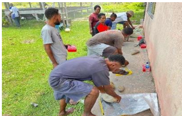
Gambar 4. Proses penghancuran tempurung yang telah dikarbonisasi.
